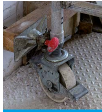
Hamulec rusztowania przejezdnego.
